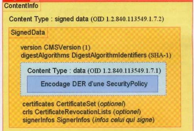
Figure 6 : Structure d'un message CMS
