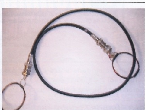
3 Sondes reliées entre elles par un câble coaxial, formant la « rallonge » pour l'attaque par relais
