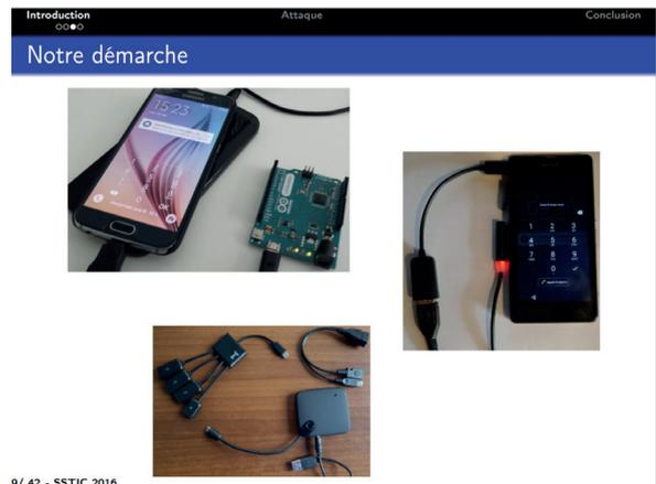
Une webcam, connectée à l'ensemble, sera utilisée pour prendre une photo à chaque tentative de déverrouillage. Une comparaison en temps réel des photos prises avec une photo étalon permettra alors de détecter le déverrouillage de l'appareil. Sur la plupart des téléphones Android, il suffira d'une vingtaine de minutes pour tester 100 mots de passe différents.
